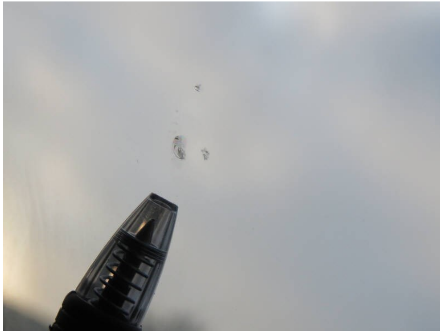
Bild 7 Frontscheibe Steinschlag mit Rissbildung
