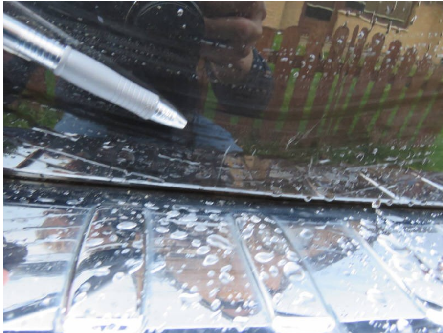
Bild 11 Heckklappe unterhalb verschürft
