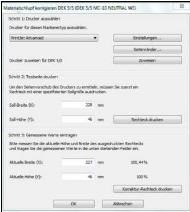
Abbildung 104 Materialschlupf – gemessene Werte eingeben
